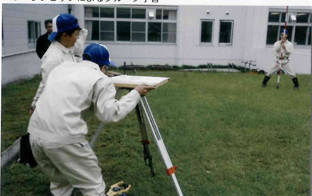
▲平板測量実習で導線法を学習
