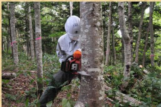
木を木材として利用するためにチェーンソーで伐り倒します。安全に木を倒すためには、倒れる側の切り口=受け口、倒すのと反対側の切り口=追い口を正確につくる必要があります。安全に伐倒するために、学校で、演習林で何度も練習を重ねます。皆、緊張の面持ちです。
